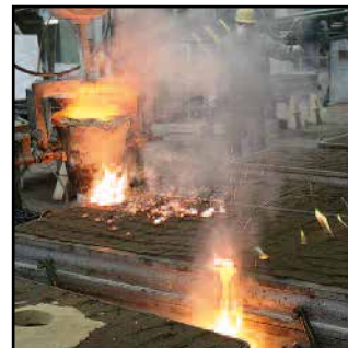
Flytende bronse fylles i sandformer ved ca.1100 grader
