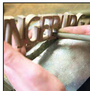
Siseling/bearbeiding av skrift
