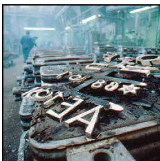
Når bronseartikkel er støpt, blir sandform ødelagt.
