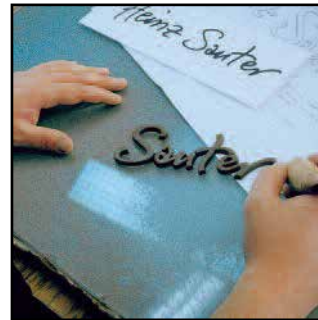
Voksmodell som sjablong til produksjon for støpeform
